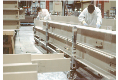
El montaje en fábrica de las vigas de soporte puede incluir el ensamblaje de los ángulos y chapas de unión previamente perforados.
