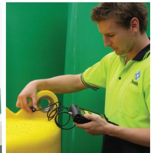
Un test ultrasónico asegura la consistencia del espesor de la pared en zonas clave como los puntos de amarre
